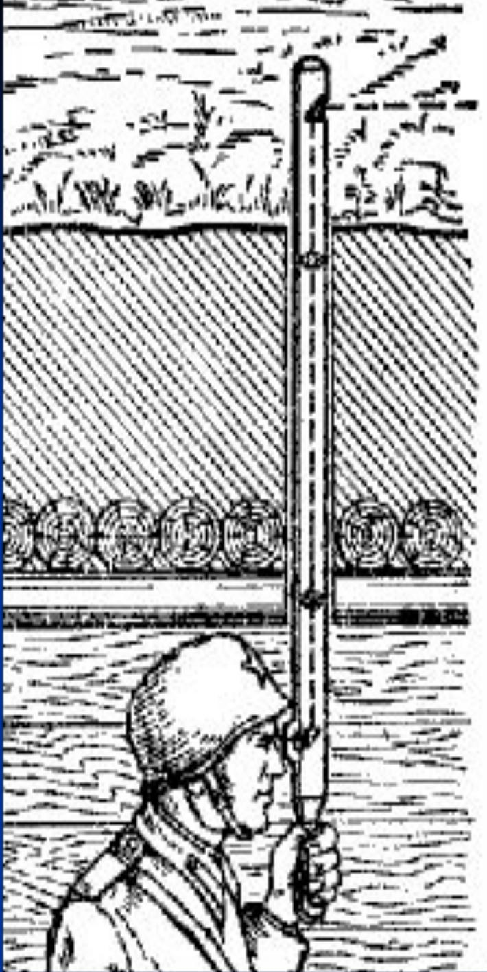
Перископы позволяют вести круговое наблюдение за местностью при минимальных размерах смотровых отверстий. Используется перископ и на подводных лодках для визуального наблюдения за противником. Перископ телескопически выдвигается над поверхностью воды, а сама подводная лодка в это время находится под водой.
