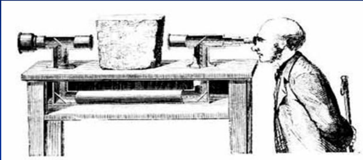
Это устройство состояло из зрительной трубы, разъятой по середине (куда был помещен толстый камень) и содержащей четыре плоских зеркала под углом  $45^\circ$ . Так впервые рекламировался новый оптический прибор – перископ.
