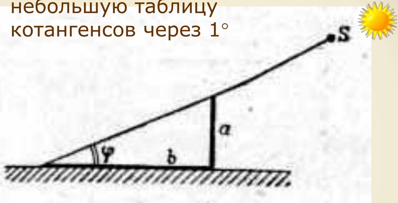
Решая задачу об определении высоты Солнца  $S$  по тени  $b$  вертикально стоящего шеста  $a$  (см чертеж), он пришел к выводу, что острый угол  $\phi$  в прямоугольном треугольнике определяется отношением одного катета к другому, и вычислил небольшую таблицу котангенсов через  $1^\circ$ . Точнее говоря, он вычислил длину тени  $b = a \cdot \frac{\cos \phi}{\sin \phi} = a \cdot \text{ctg} \phi$  шеста определенной длины для  $\phi = 1^\circ, 2^\circ, 3^\circ \dots$
