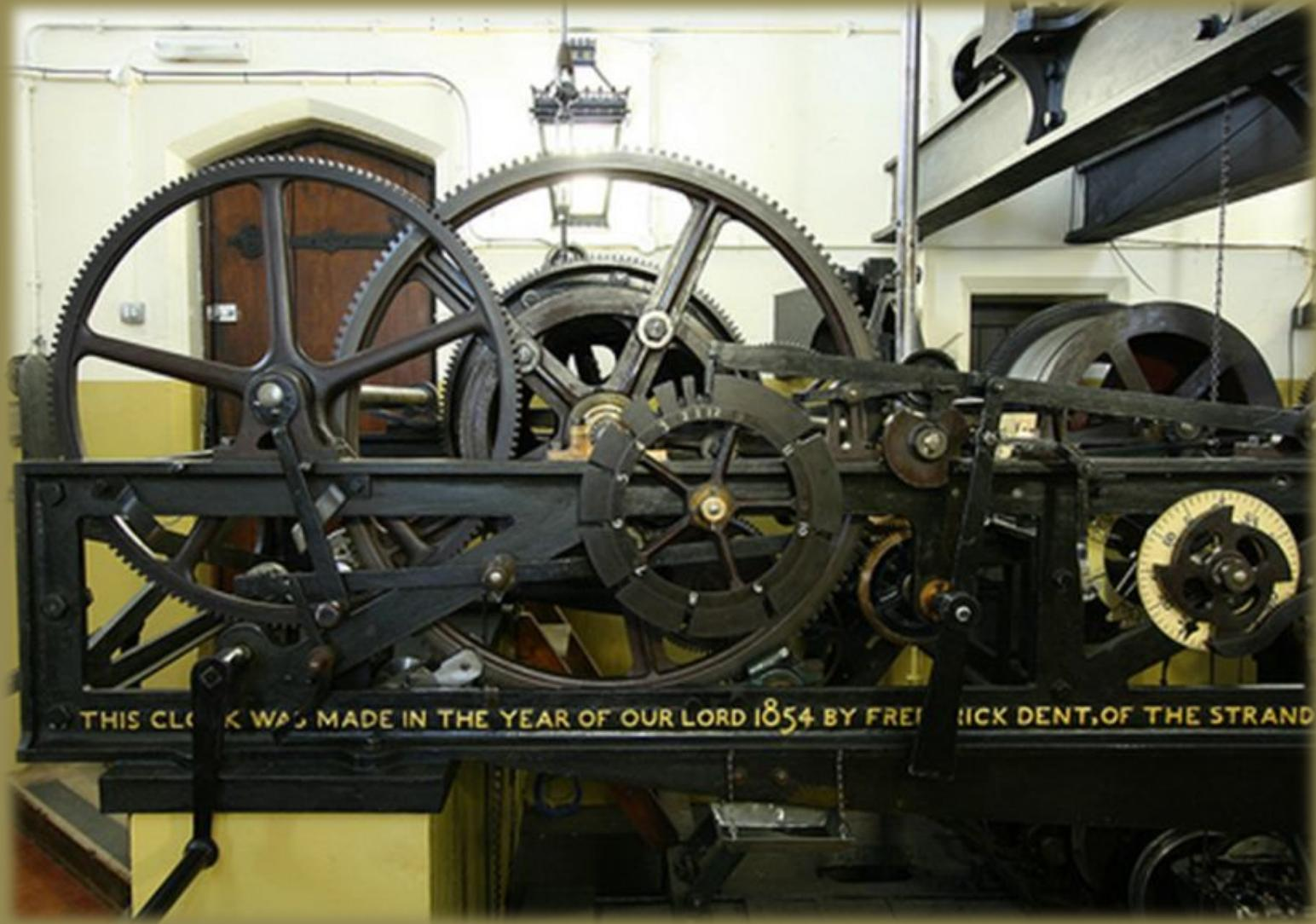
Механизм, приводящий в действие молот колокола Биг-Бен.
