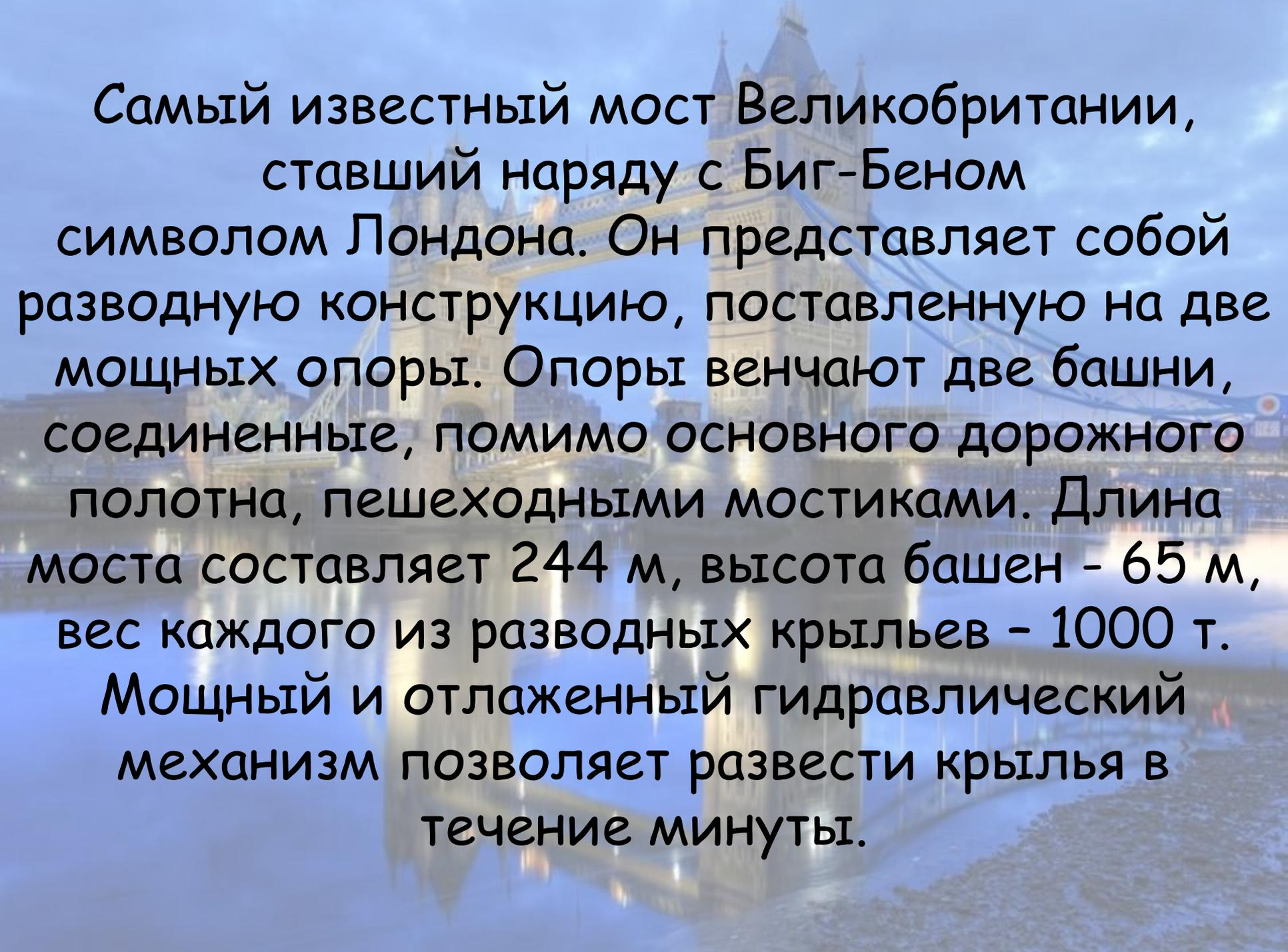
Самый известный мост Великобритании, ставший наряду с Биг-Беном символом Лондона. Он представляет собой разводную конструкцию, поставленную на две мощных опоры. Опоры венчают две башни, соединенные, помимо основного дорожного полотна, пешеходными мостиками. Длина моста составляет 244 м, высота башен - 65 м, вес каждого из разводных крыльев - 1000 т. Мощный и отлаженный гидравлический механизм позволяет развести крылья в течение минуты.
