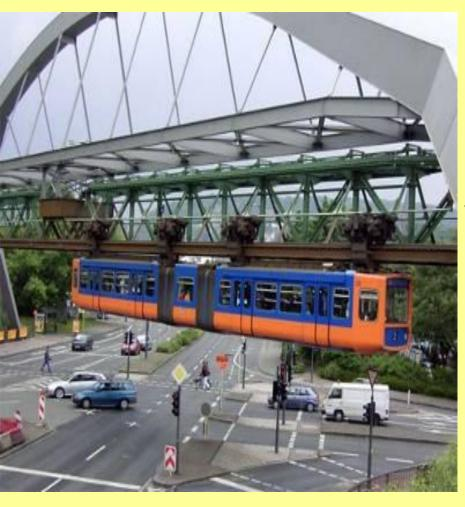
In allen Großstädten fährt die U-Bahn unter der Erde durch Tunnel. In der deutschen Stadt Wuppertal hängt die Stadtbahn an einer Konstruktion aus Stahl und schwebt in der Luft. Sie heißt "Schwebebahn".
