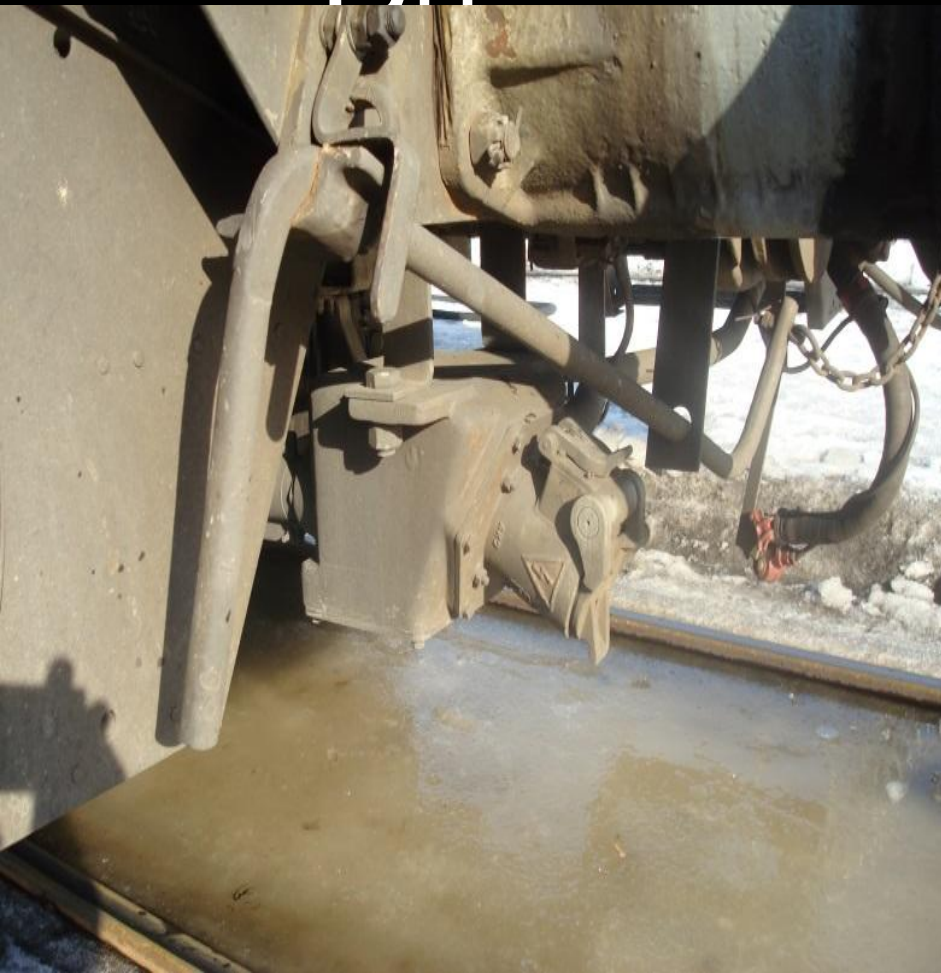
Розетка высоковольтного отопления
