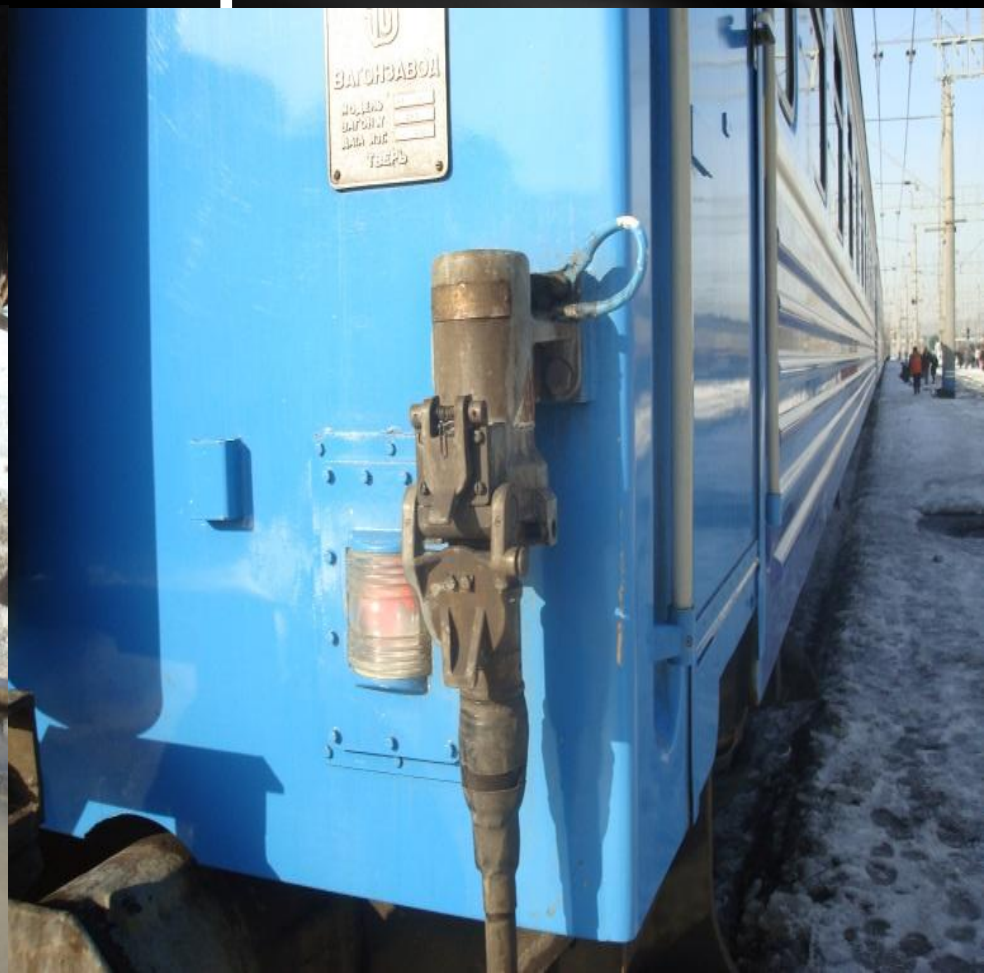
Холостая розетка высоковольтного отопления
