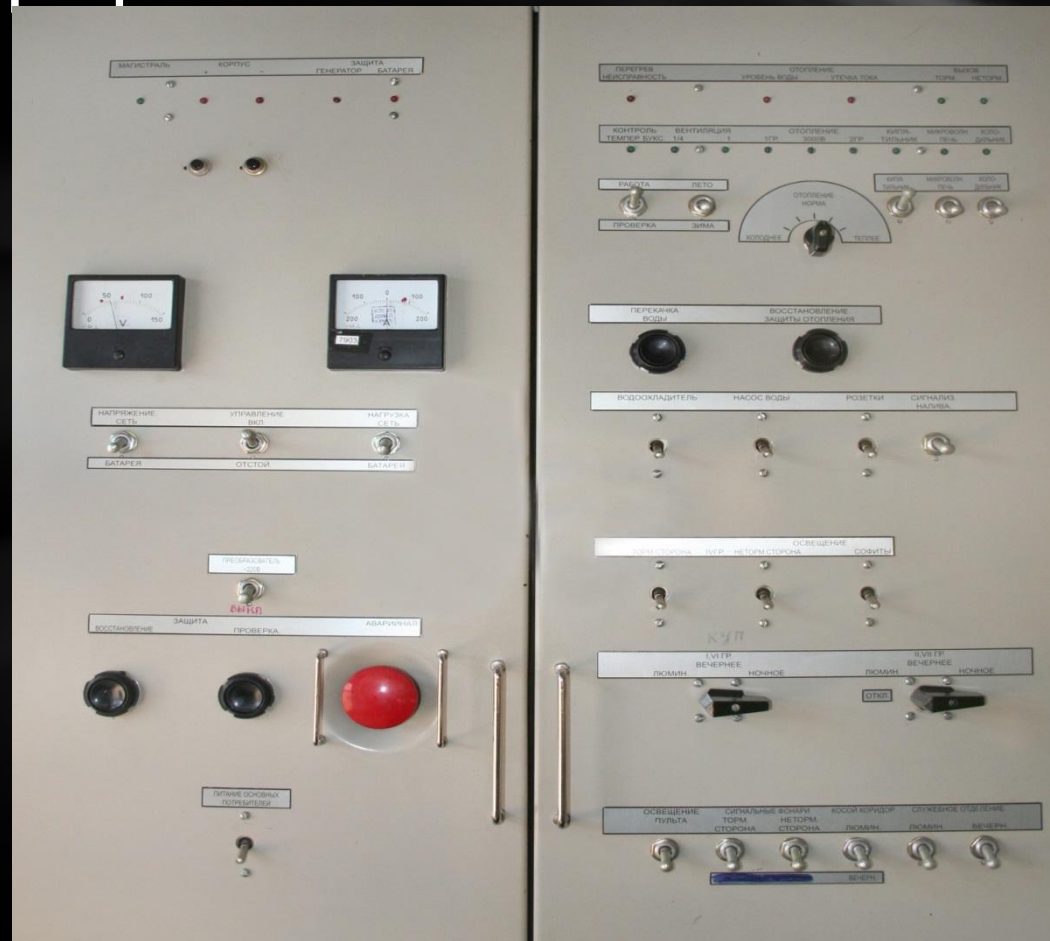
Электроцит купейного вагона 55В производства ТВЗ
