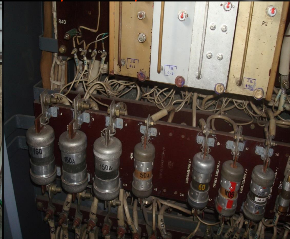
Нижняя панель предохранителей плакартного вагона производства КВЗ
