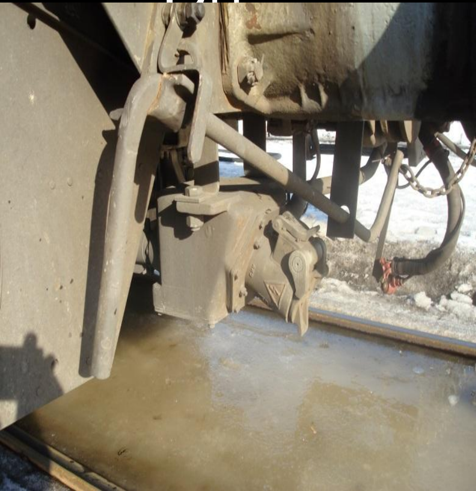
Розетка высоковольтного отопления
