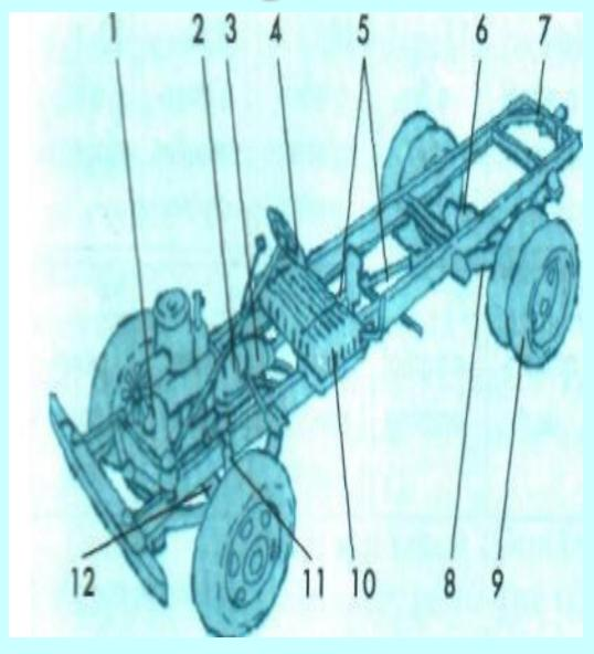
(двигатель), 2 - clutch (сцепление), 3 -gearbox (коробка передач), 4 - steering system (рулевое управление), 5 - drive shaft (карданная передача), 6 - driving rear axle (ведущий задний мост). 7 -frame (рама), 8 - plate spring (peccopa), 9 - wheel (колесо), 10 - gas tank (топливный бак), 11 - shock absorber (амортизатор), 12 - front axle (передний мост)
