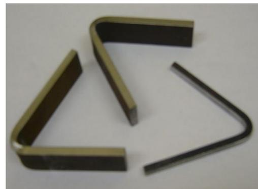
**Bimetal specimens after testing at an angle of 120 °: lateral bending and bending of the front and back side out** (образцы биметалла после испытания на угол 120°: боковой изгиб и изгиб лицевой и тыльной стороной наружу)
