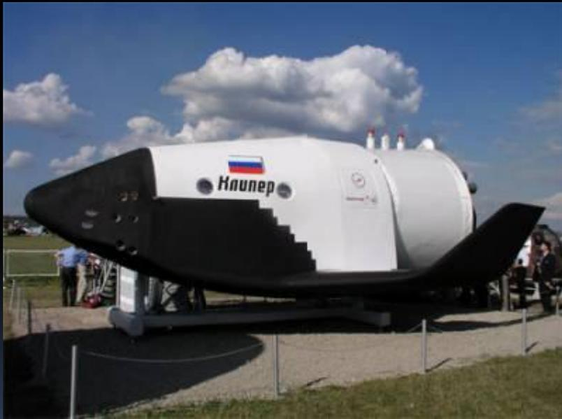
Итак ПКК "Клипер" – это многоцелевой многоцелевой космический корабль, способный выполнять полет как в пилотируемом, так и в беспилотном (автоматическом) варианте. Он разработан как составляющая транспортной системы для обслуживания орбитальных станций на околоземных орбитах высотой до 500 км.
