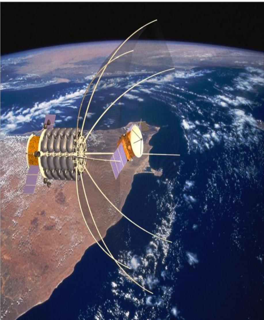
Космическая система предназначена для эффективного увода с низких околоземных орбит (высотой до 1 000 км) в плотные слои атмосферы средних объектов космического мусора (массой до 1 000 кг и габаритами до 5 м).
