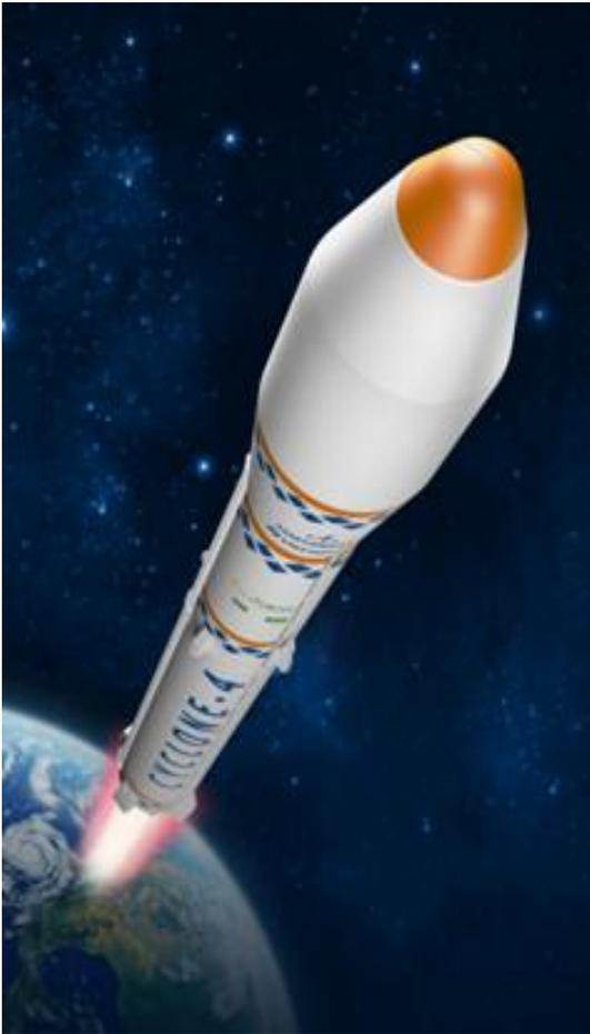
Ракета-носитель «Циклон-4» предназначена для оперативного, высокоточного выведения на круговые, геостационарные и солнечно-синхронные орбиты одного или группы космических аппаратов различного назначения.
