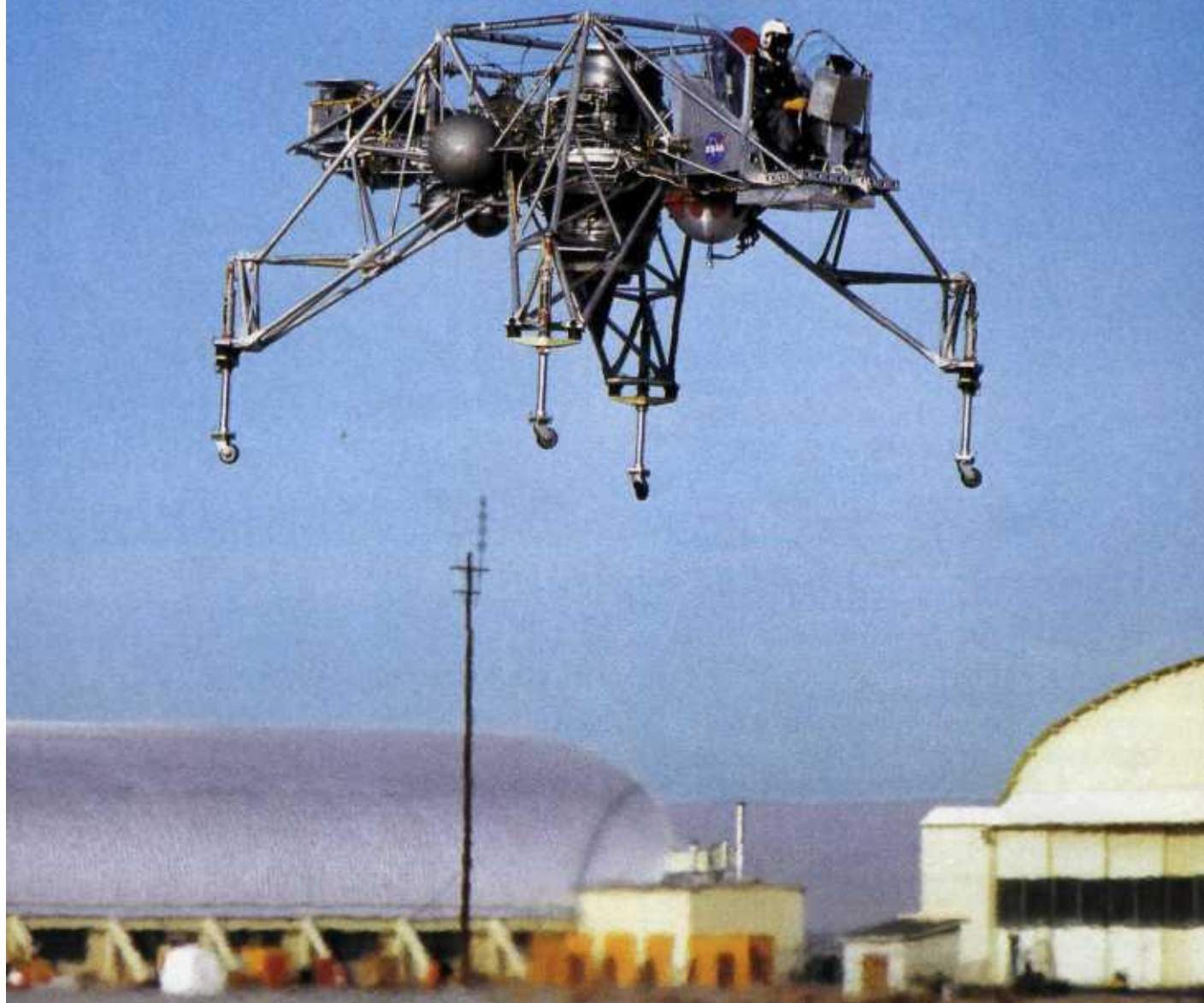
Наземные испытания прототипа посадочной ступени лунного модуля «Аполло» (США, 1966 г.)
