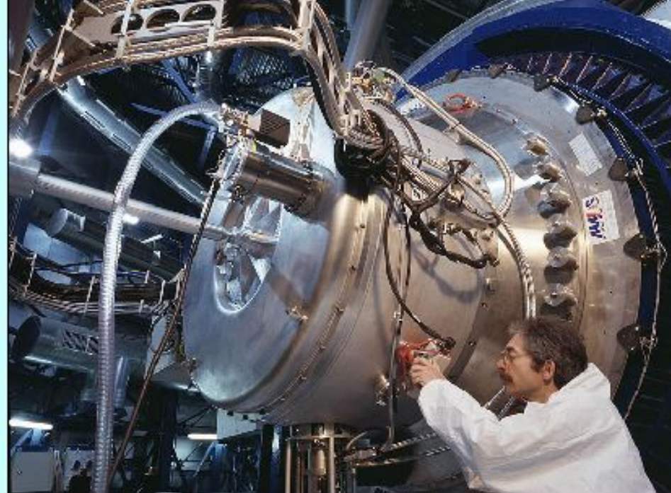
Инфракрасная камера 8-метрового телескопа VLT
