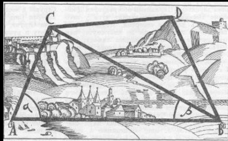
По базису (AB) и углам  $\alpha$  и  $\beta$  определяют сторону BC. Продолжая измерения, покрывают Землю сетью треугольников. Так можно вычислить расстояние между любыми 2 точками на поверхности Земли.
