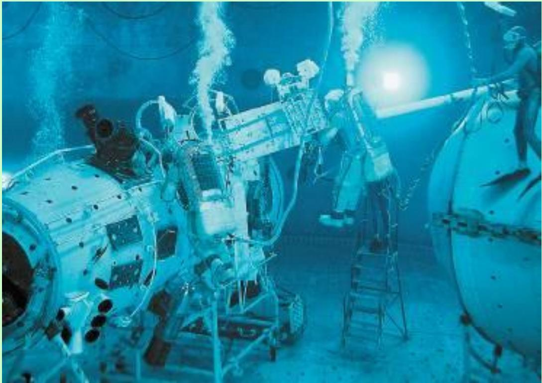
В Центре подготовки космонавтов построили гидробассейн и создали гидролабораторию. Бассейн представляет собой цилиндр диаметром 23 м и высотой 12 м с вмонтированными в него иллюминаторами.
