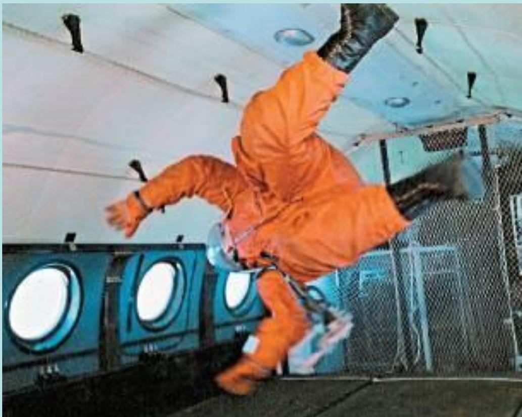
Самая "чистая" невесомость возникает в самолёте при полёте по параболической траектории. В самолете Ту-104 создали «летающую лабораторию», в которой можно свободно "плавать" и отрабатывать элементы полётного задания, но невесомость длится не более 20 с.
