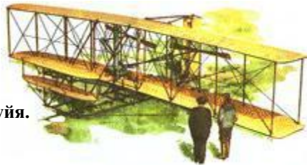
"Флайер" относится к типу биплана с коробчатым крылом.
