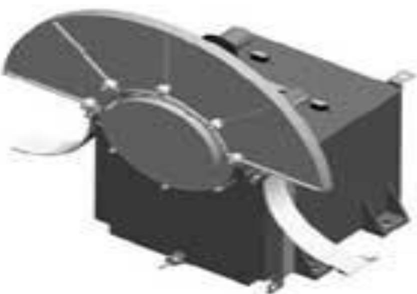
Роль спектрометра энергичных частиц PEPSSI (Pluto Energetic Particle Spectrometer Science Investigation) состоит в поиске нейтральных атомов в атмосфере Плутона, которые приобретают заряд под действием ультрафиолета и уносятся с солнечным ветром. В целом его задачи во многом схожи с тем, чем будет заниматься прибор SWAP, но PEPSSI сможет определять энергию частиц вплоть до 1000 кэВ
