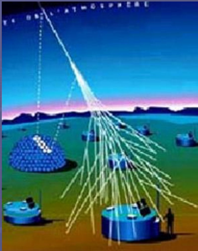
Рис. 6. Принципиальная схема детектирования ШАЛ в обсерватории Всемирная сеть гамма-телескопов.
