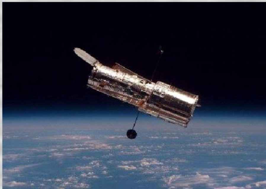
Телескоп Хаббл (HST), работает с 25.04.1990г. Длина - 15,1 м, вес 11,6 тонн, зеркало 2,4 м
