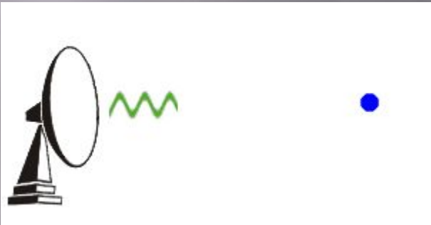
Принцип действия импульсного радара
