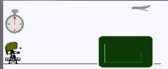
Принцип определения расстояния до объекта с помощью импульсного радара
