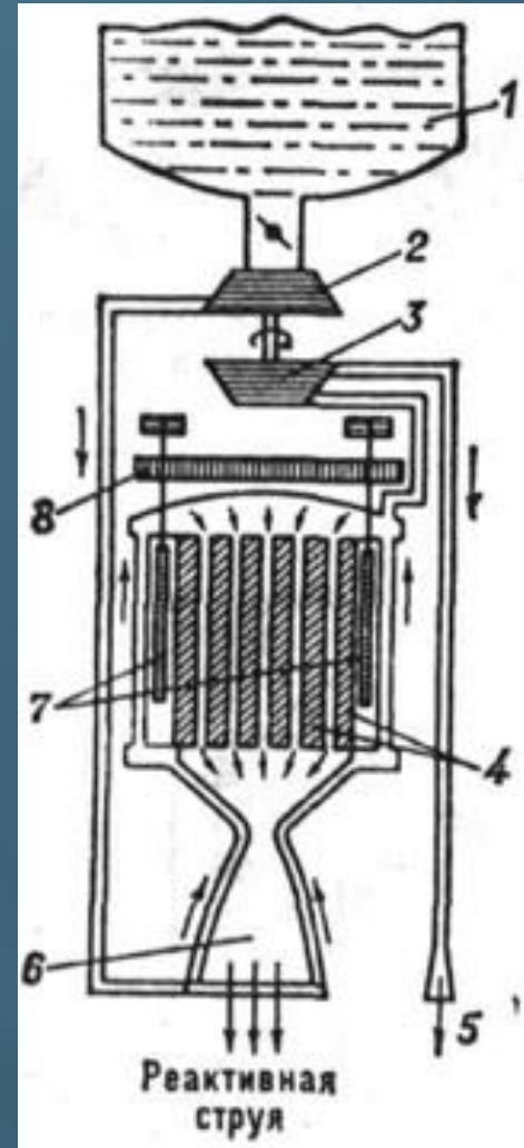
(сверху)Принципиальная схема ядерного ракетного двигателя: 1 - бак с жидким водородом; 2 - насос; 3 - турбина; 4 - тепловыделяющие элементы; 5 - выпуск газов из турбины; 6 - сопло; 7 - стержни управления; 8 - защитный экран
