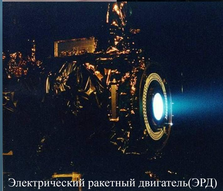
Электрический ракетный двигатель (ЭРД)
