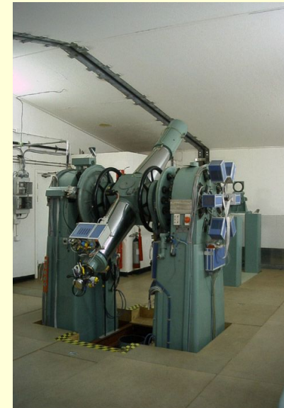
CARLSBERG MERIDIAN TELESCOPE. D = 176 \text{ мм} , F = 2.7 \text{ м} . ПЗС-камера: 2K (drift scan mode). Рабочее поле: 20\text{min} - 5 \times 24 \text{ arcmin}
