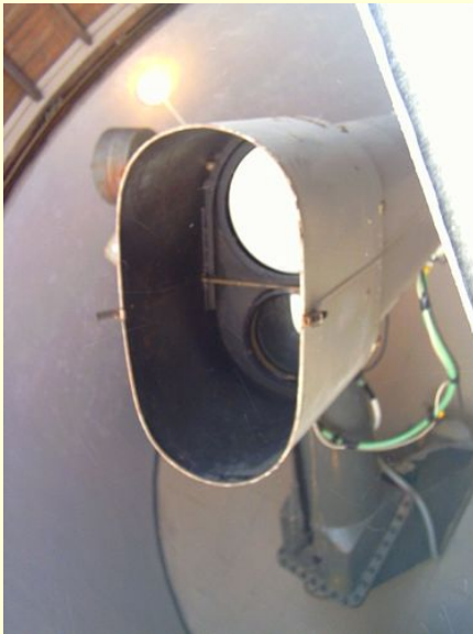
Нормальный астрограф Пулковской обсерватории. D = 330\text{мм} , F = 3.5\text{м} . ПЗС-камера: S2C. Рабочее поле: 18 \times 16 \text{ arcmin}
