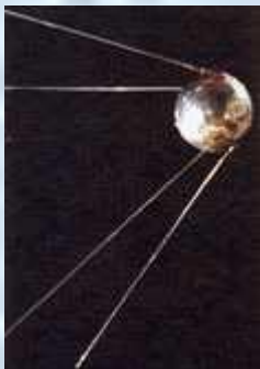
Первый ИСЗ. Шар диаметром 58 см и весом 83,6 кг
