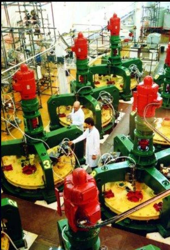
Подземная лаборатория галлий-германиевого нейтринного телескопа (ГГНТ) для детектирования солнечных нейтрино с мишенью из 60 тонн металлического галлия, расположенного на расстоянии 3,5 км от входа в тоннель.
