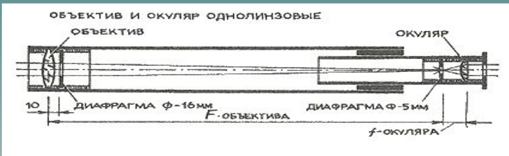
Та, что направляется на светило (объектив), может быть простым очковым стеклом. Хорошо, если вы найдете очковое стекло +1 диоптрия. Фокусное расстояние такой двояковыпуклой линзы - 1 метр. Значит, труба вашего телескопа должна быть примерно такого размера. Линза, в которую наблюдатель рассматривает изображение светила, называется окуляром. В качестве окуляра используйте лупу - короткофокусную линзу.
