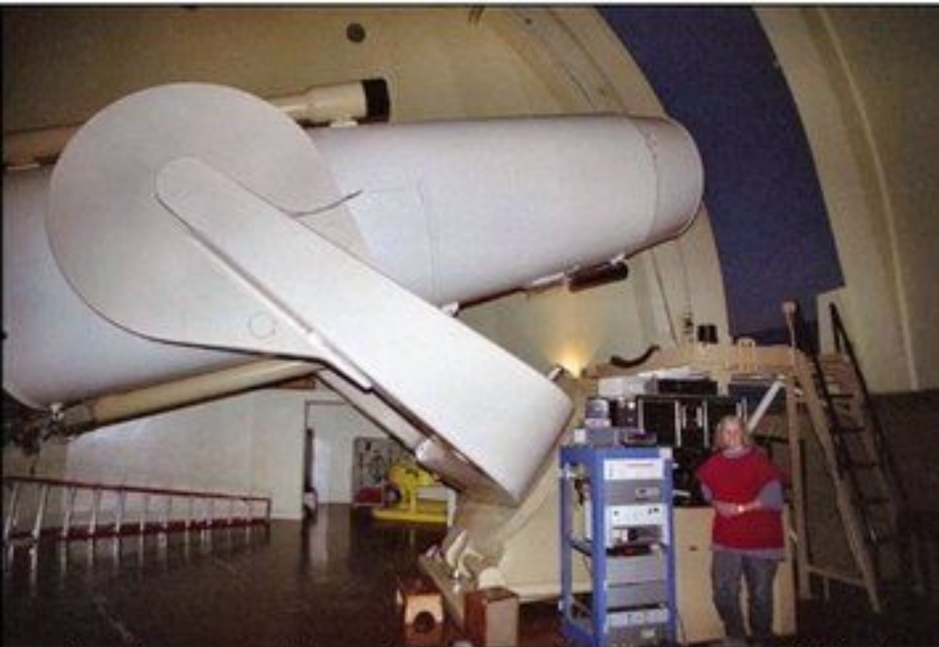
48-дюйм камера Шмидта Паломарской обсерватории (1948 г.) Первый в мире обзорный телескоп
