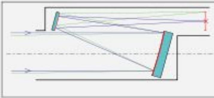
Оптическая схема брахита
