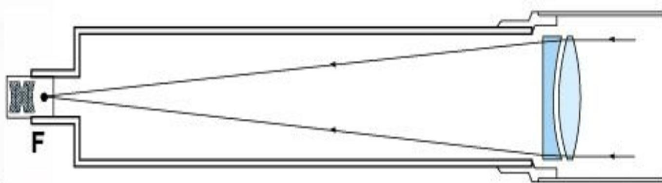
Преломляющие телескопы, или рефракторы, в качестве главного светособирающего элемента используют большую линзу-объектив. Рефракторы всех моделей и апертурах включают ахроматические (двухэлементные) объективные линзы - таким образом сокращается или практически устраняется ложный цвет (хроматическая aberrация), который влияет на получаемый образ, когда свет проходит через линзу.
