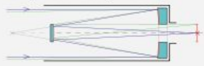
Оптическая схема телескопа Ричи—Кретьена—Кассегрена
