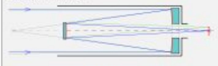
Оптическая схема телескопа Кассегрена
