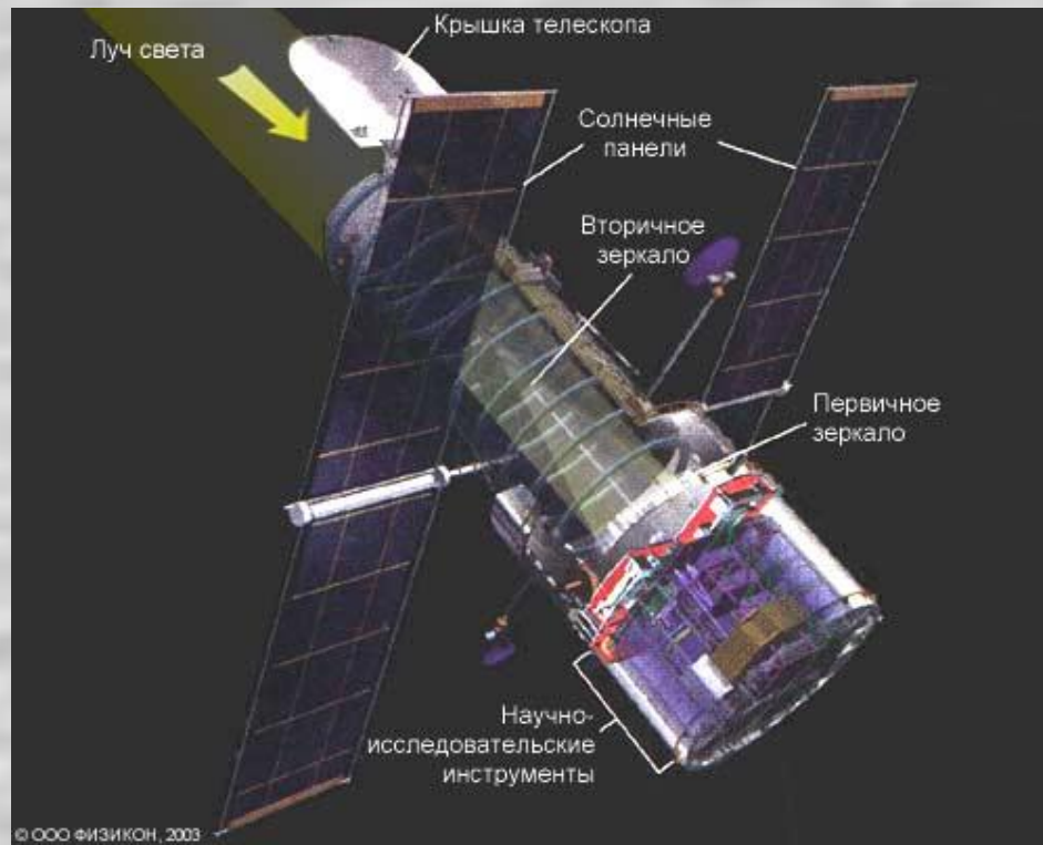
Телескоп Хаббл (HST), работает с 25.04.1990г. Длина - 15,1 м, вес 11,6 тонн, зеркало 2,4 м
