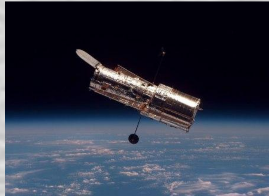
Телескоп Хаббл (HST), работает с 25.04.1990г. Длина - 15,1 м, вес 11,6 тонн, зеркало 2,4 м
