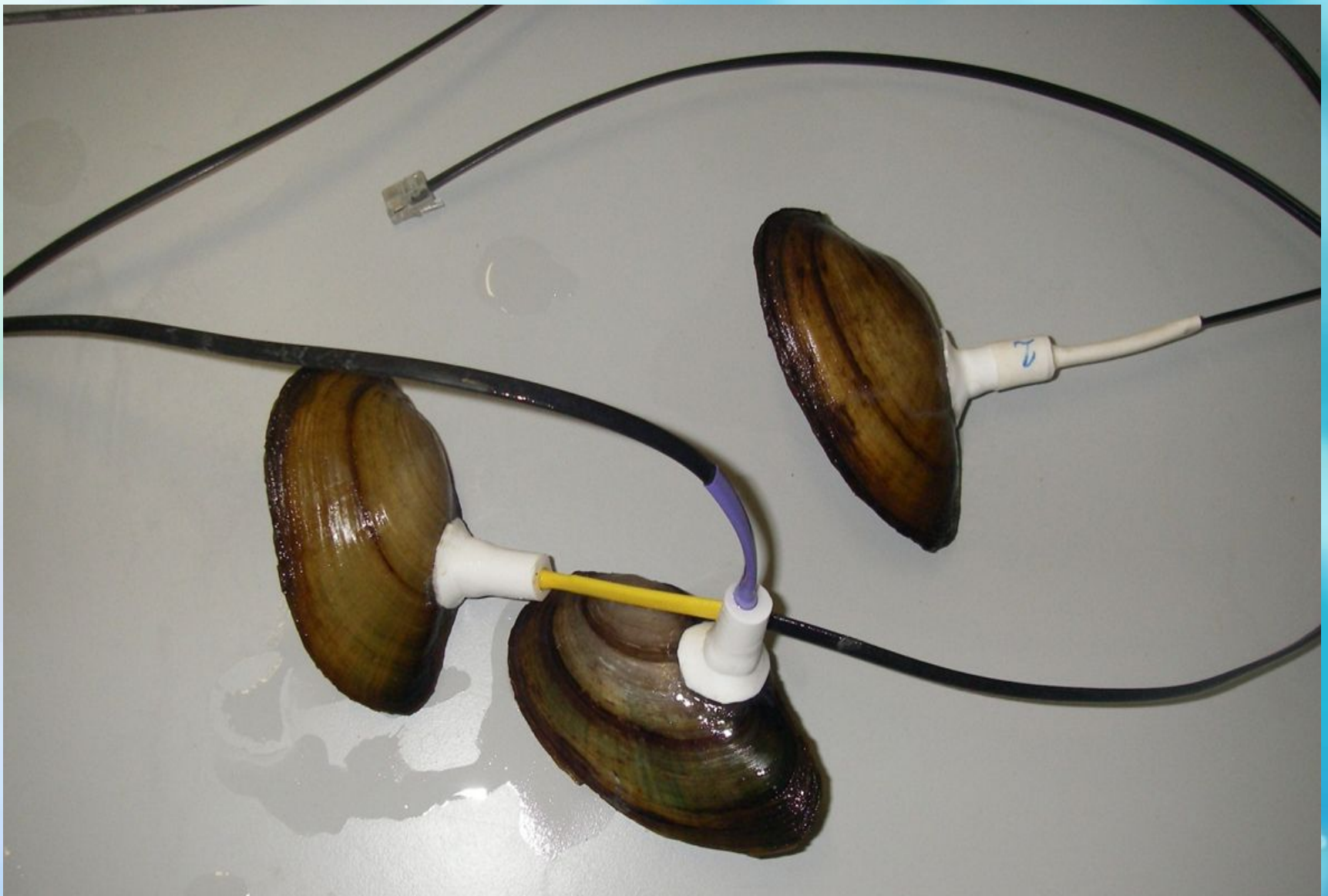
Датчики, наклеенные на створки моллюсков
