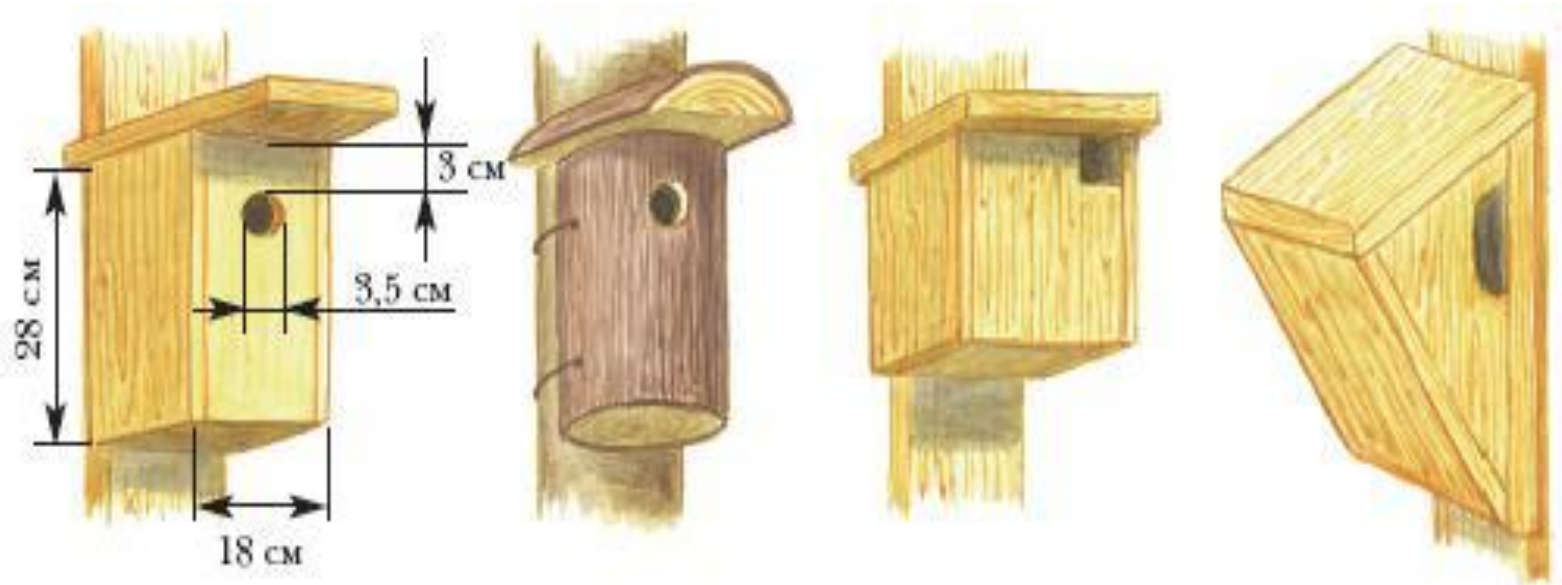
Рис. 187. Искусственные гнездовья для привлечения насекомоядных птиц
