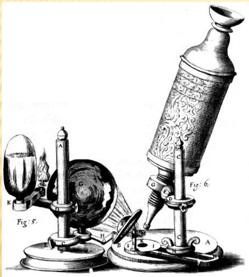
Микроскоп Гука (гравюра из «Микрографии»)
