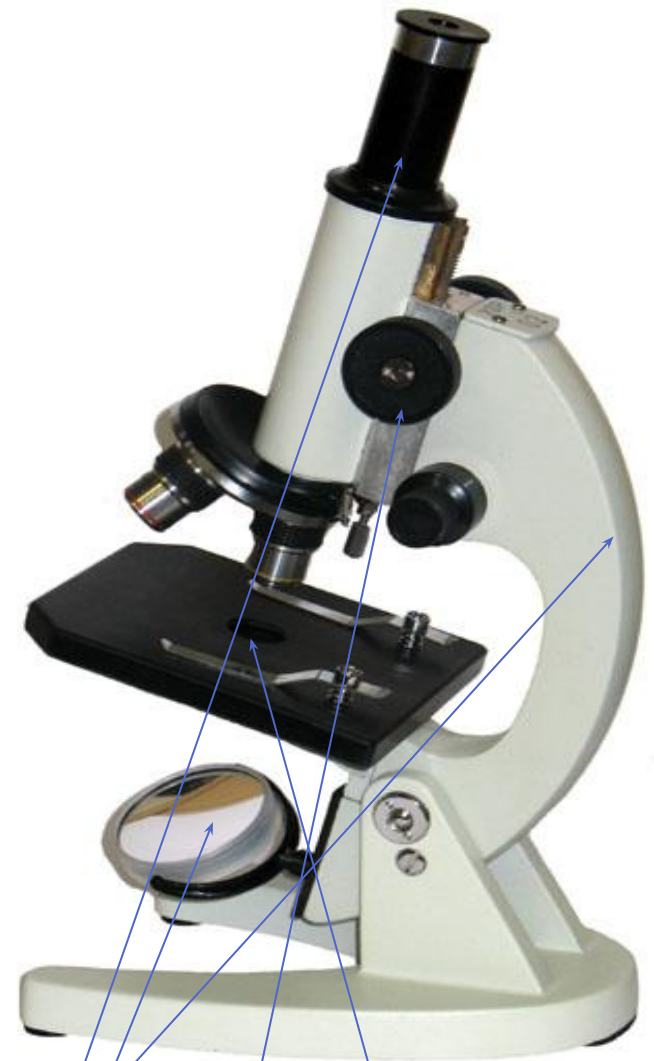
Штатив, предметное стекло, тубус, окуляр, объектив, зеркало, винт
