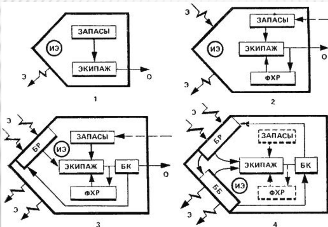
Схемы основных типов систем жизнеобеспечения космических экипажей: 1 – система на запасах (все отходы удаляются); 2 – система на запасах с частичной физико-химической регенерацией веществ (ФХР) (часть отходов удаляется, часть запасов может возобновляться); 3 – система с частичной ФХР и частичной биологической регенерацией веществ растениями (БР) с блоком коррекции отходов (БК); 4 – система с полной замкнутой регенерацией веществ (запасы ограничены микродобавками).
