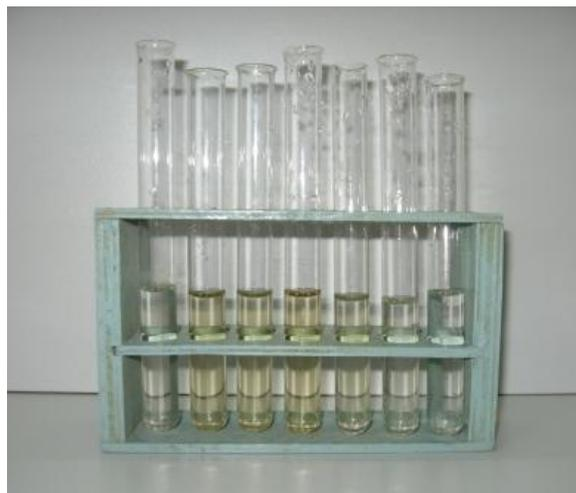
Пробы воды после добавления реактива – раствора нитрата серебра
