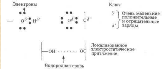
Рис. 5.30. Образование водородной связи.
