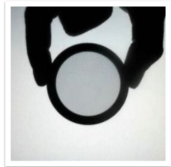
Рис.1 - Ограничение прохождения поляризованного света можно осуществить простым поворачиванием фильтра.
