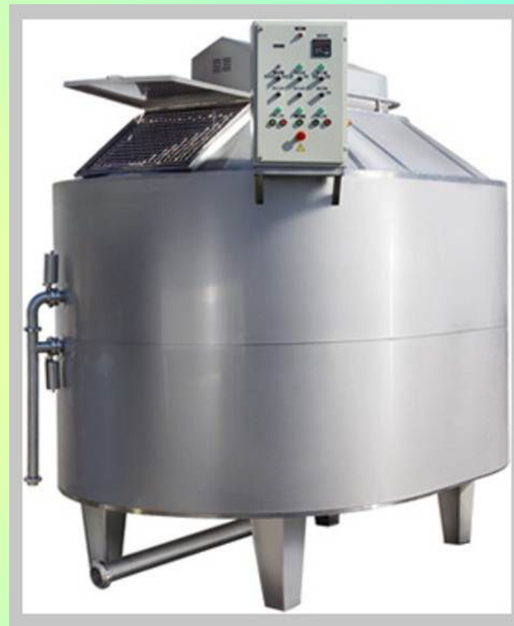
Аппарат, в котором под действием пара происходит процесс свертывания молока.
