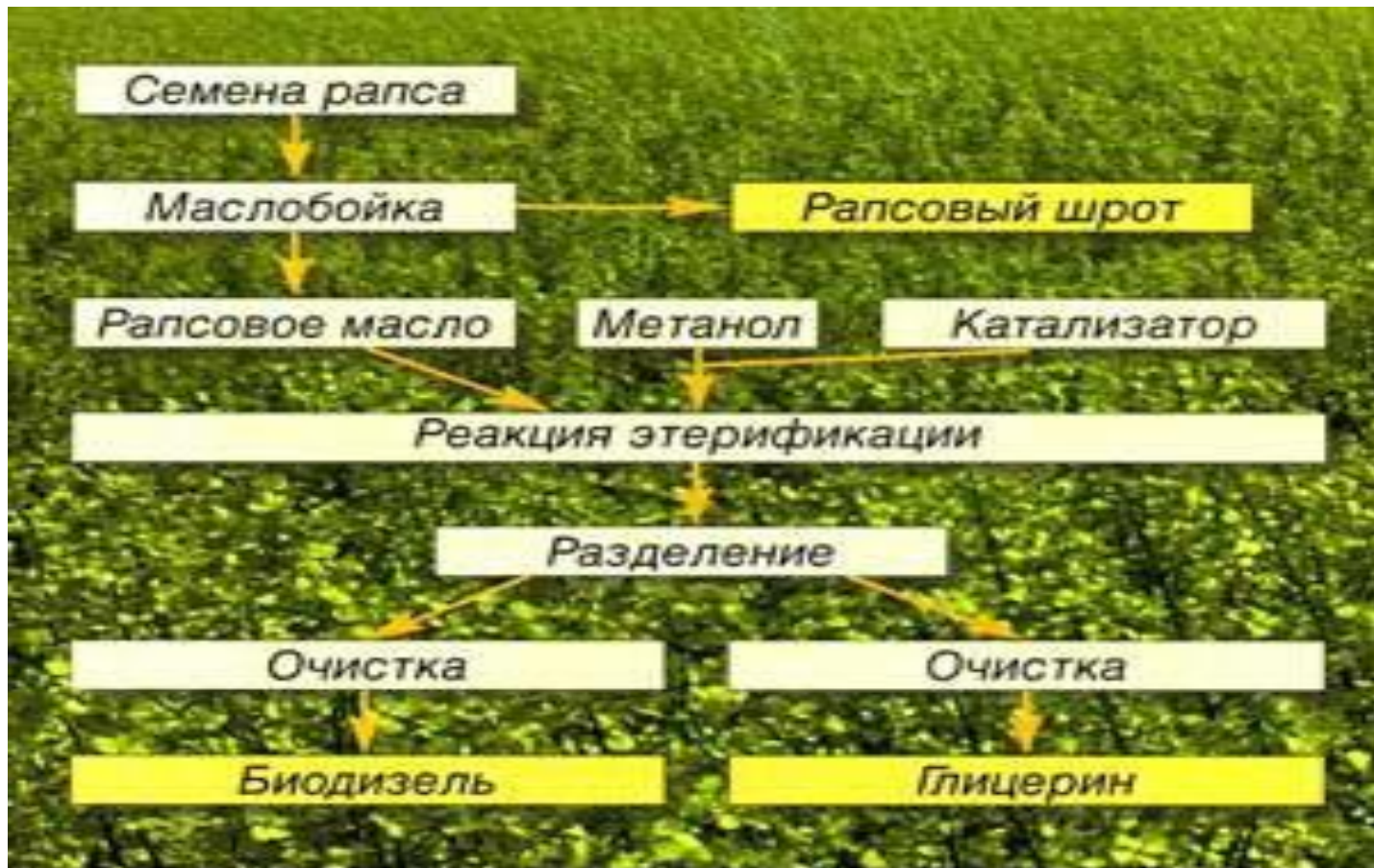
Рис. 1 Процесс получения биодизеля и побочного продукта глицерина из рапса
