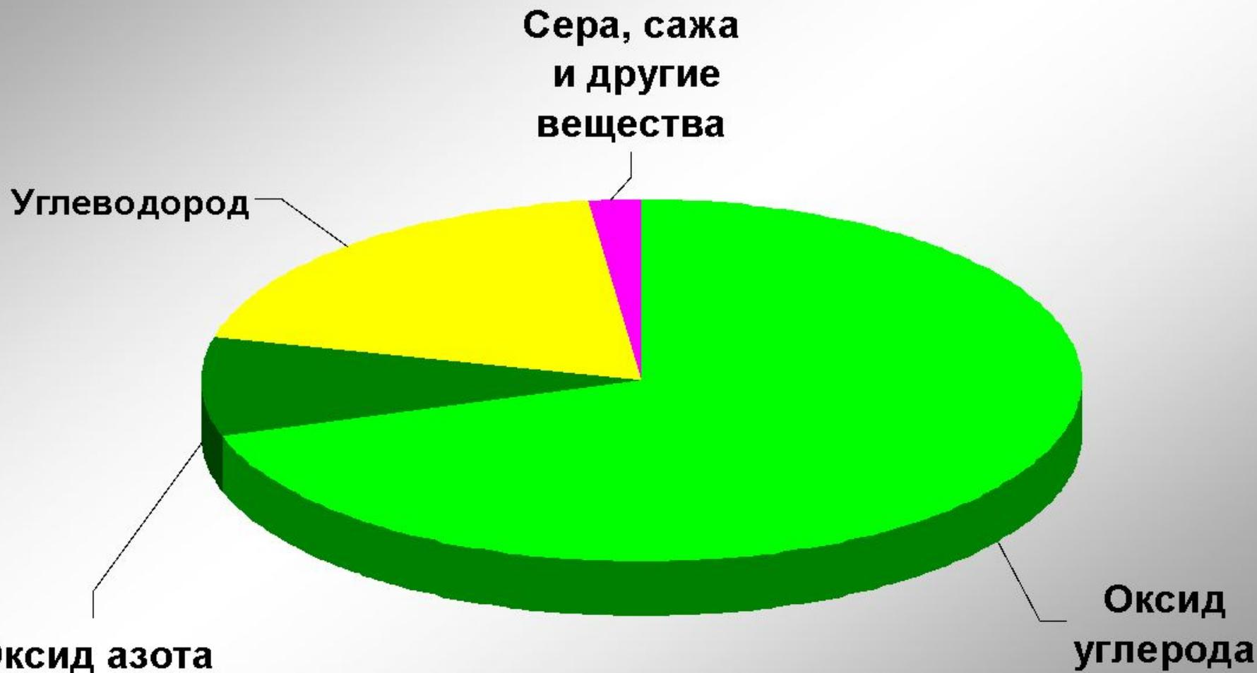
**Количество вредных веществ, поступающих в атмосферу в составе отработавших газов, зависит от общего технического состояния автомобилей**
