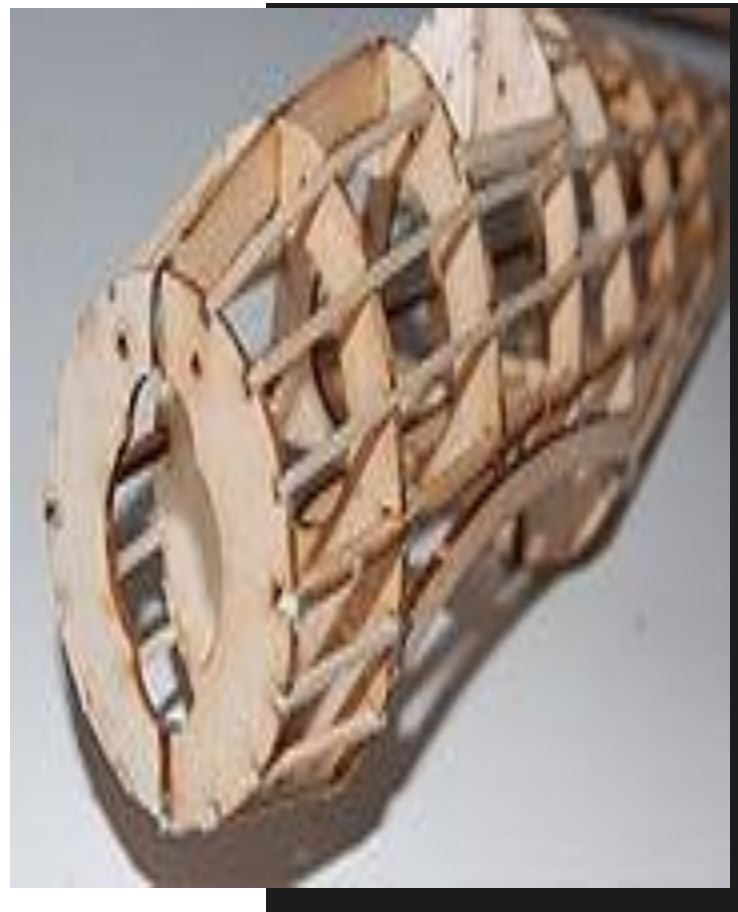
Модель детали самолета из бальзы.
