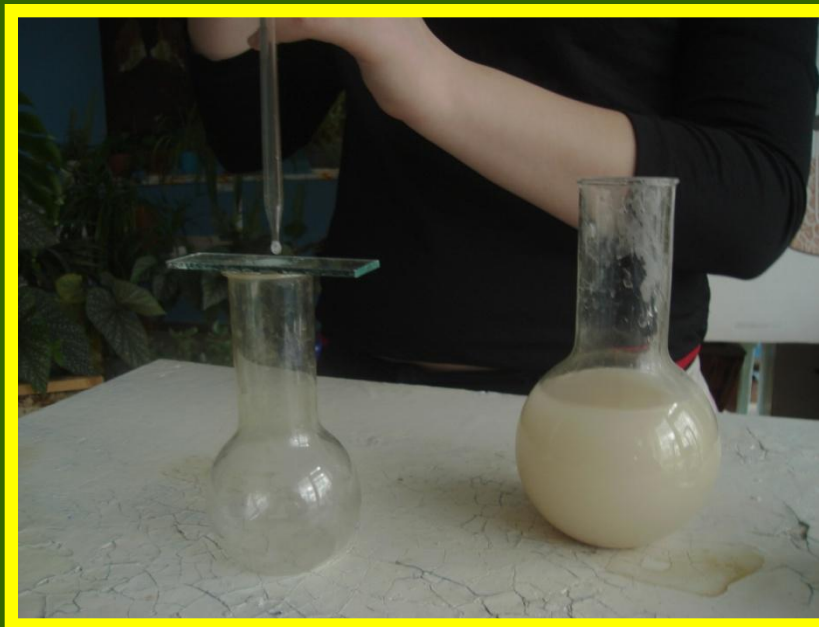
Рис 13. Нанесение капли суспензии дрожжей на предметное стекло
