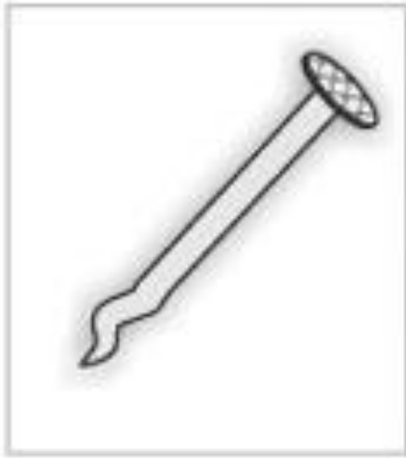
Изменение формы гвоздя при ударе молотком
