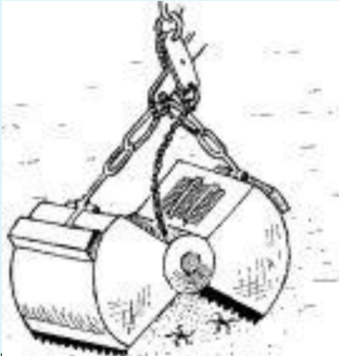
ДНОЧЕРПАТЕЛЬ - гидробиологический прибор для взятия проб бентоса. Изобретен К. Г. Петерсоном (1915)
