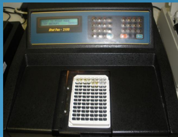
Stat Fax 2100 измеряет оптическую плотность раствора.
