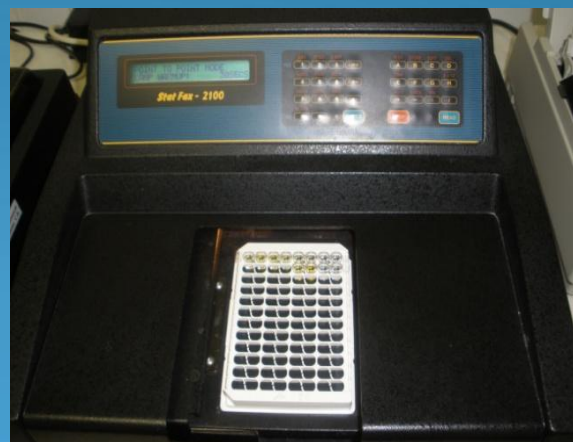
Stat Fax 2100 измеряет оптическую плотность раствора.
