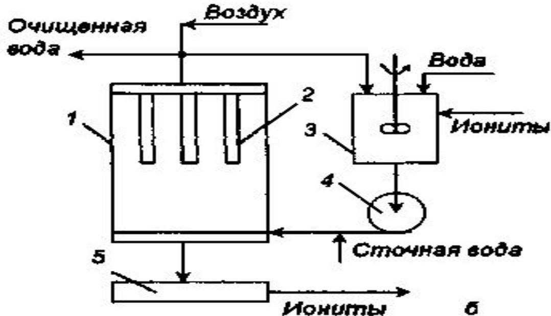
1 — корпус, 2 — фильтрующий элемент, 3 — емкость для приготовления суспензии ионита, 4 — насос, 5 — сборник отработанного ионита
