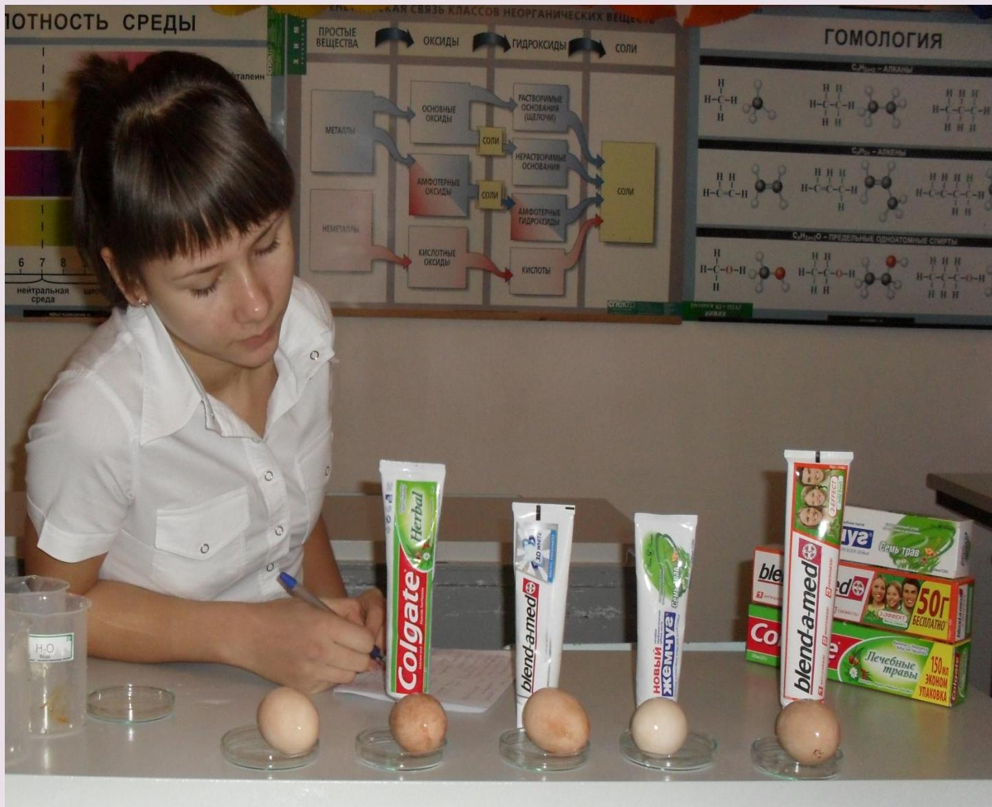
Опускаем яйца (пять обработанных пастой и одно контрольное не обработанное) в раствор уксусной кислоты. Время выдержки яиц в растворе кислоты 15 минут.
