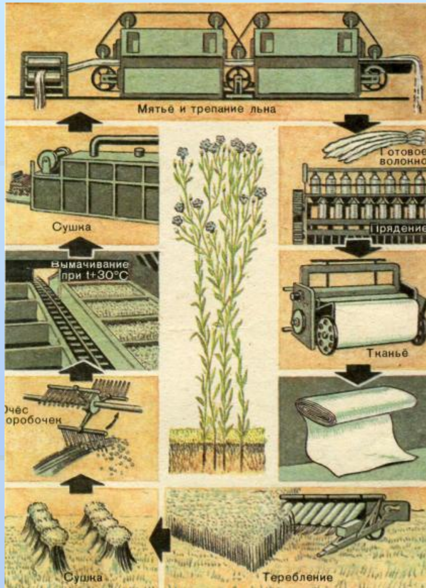
Схема, показывающая, как получают полотно из льна.
