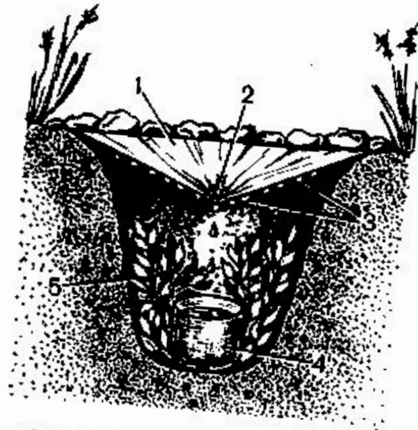
Рис. 16. Добывание воды из грунта при помощи пленочного конденсатора: 1 — полиэтиленовая пленка; 2 — груз для придания пленке формы конуса; 3 — стекающие капли конденсированной воды; 4 — емкость для воды; 5 — ветки и листья
