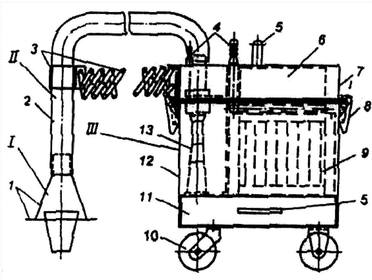
Каждый из узлов включает в себя ряд элементов (деталей): пылегазоприемник 1, эластичный воздуховод 2, шарнирно-фиксирующая опора 3, штуцеры сжатого воздуха 4, эжектор 13, корпус очистного аппарата 12, емкость для пыли 11, ролики 10, ячеистый тканевый фильтр 9, зажимы 8, съемная крышка 7, сорбент 6, ручки 5.
