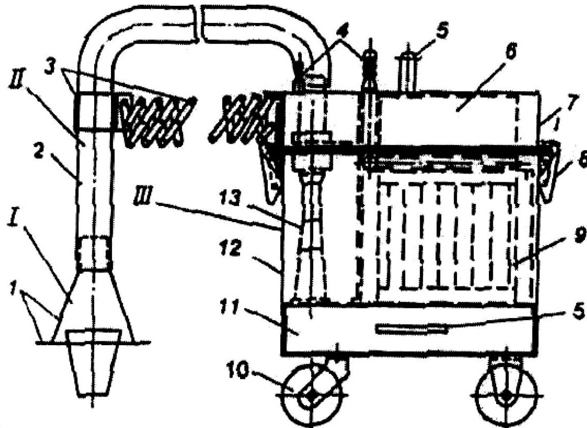
Каждый из узлов включает в себя ряд элементов (деталей): пылегазоприемник 1, эластичный воздуховод 2, шарнирно-фиксированная опора 3, штуцеры сжатого воздуха 4, эжектор 13, корпус очистного аппарата 12, емкость для пыли 11, ролики 10, ячеистый тканевый фильтр 9, зажимы 8, съемная крышка 7, сорбент 6, ручки 5.
